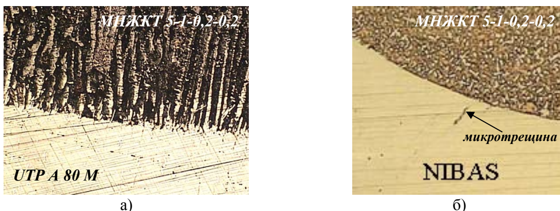
Рис. 4 – Мікроструктура лінії сплавлення МНЖКТ5-1-0,2-0,2 і підсоля УТР А 80 М (а) і підсоля Nibas 70/20-IG (б)
